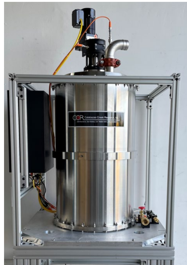
Fig. 1. 1.5 MW CW RF load
