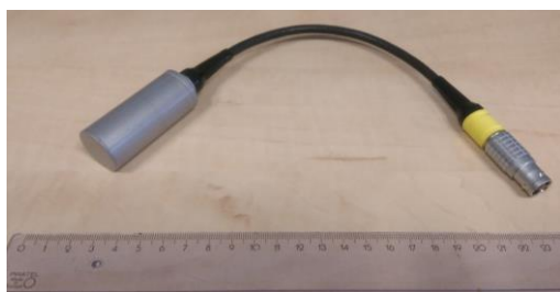
Figure 2: 500 mm 3 CZT detector.
